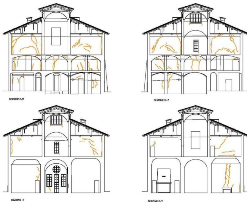
Figura 2. Rilievo del quadro fessurativo in sezione trasversale.
