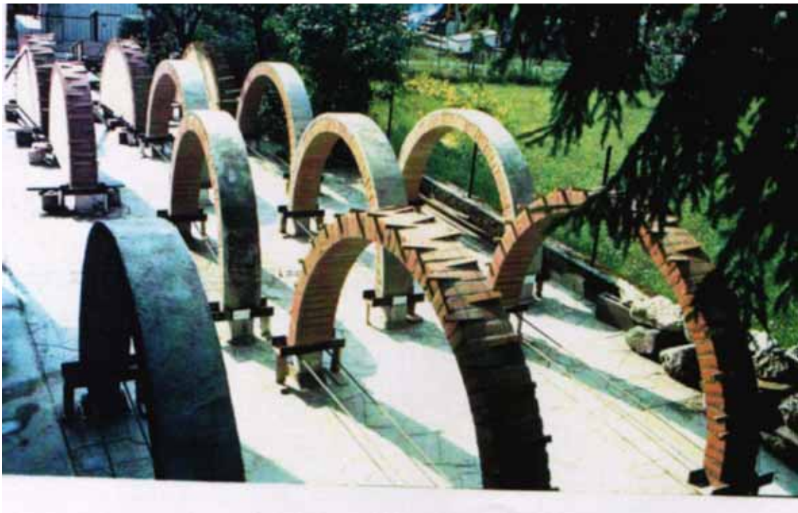
Figura 13 Modelli di archi in muratura predisposti per prove a scala reale
