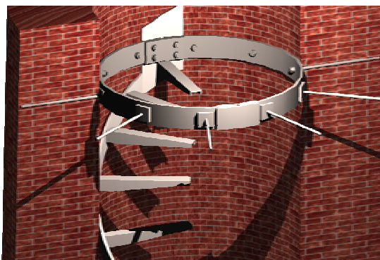
Figura 10. Dettaglio della scala elicoidale installata all'interno della ciminiera ed ancorata agli anelli di cerchiatura
