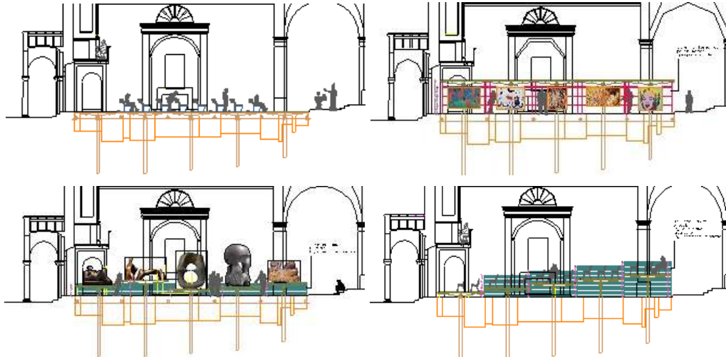
Figura 7. Possibili modalità di allestimento interno permesse dalla pavimentazione ad assetto variabile.
