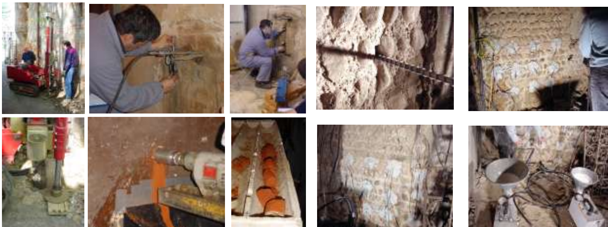
Figura 3. Prove penetrometriche, martinetti piatti, prove di iniettabilità della muratura.
