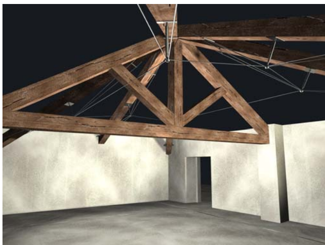
Figura 6. Modelli digitali del consolidamento delle strutture lignee di copertura ottenuto mediante cavi e puntoni metallici.
