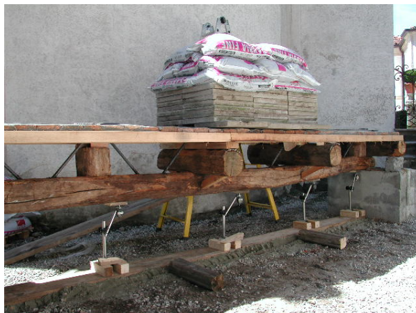
Figura 4. Prova di carico su una porzione di solaio ricostruita e consolidata con connettori metallici diagonali.
