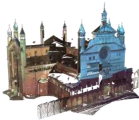
Figura 3. Restituzione di una vista tridimensionale con rilievo laser-scanner.
