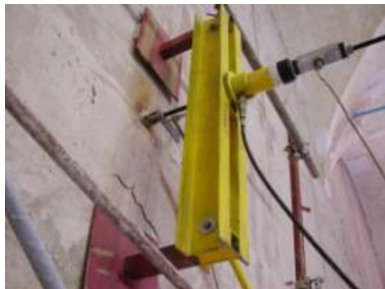
Figura 5. Prove di pull-out sulle murature presso l'Ex Convento di san Cristoforo a Lodi
