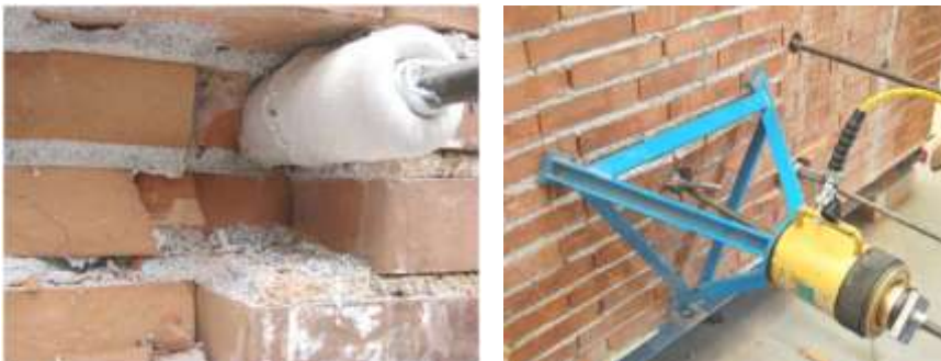
Figura 4. Prove di pull-out su murature condotte presso l'Università di Bergamo
